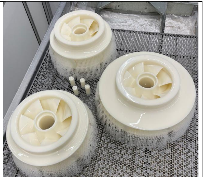
Drei Laufräder auf einer Druckplattform vor dem Post Processing (Bild: KSB)
