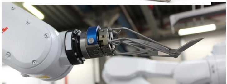
Abb.: Serienproduktion der Messer (li), Komponente mit Luftkanälen, Scharnier und definiert rauher Oberfläche (re.o.), montiert auf dem Roboterarm für den Produktionsbetrieb (re.u.).
