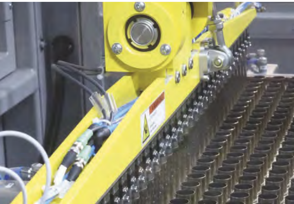
Orientiertes Handling in den automatisierten Produktionslinien für tiefgezogene Batteriegehäuse für zylindrische Li-Ionen Zellen ist essenziell, um den hohen Qualitätsanforderungen gerecht zu werden. Essential to meet the high-quality requirements of deep drawn cylindrical battery cans is the orientated handling throughout the fully automated production line. Bild/Picture: H&T Battery Components
