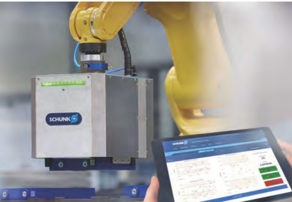
Durch intelligente Greifsysteme ist es möglich qualitätskritische Parameter der Batteriezeile während der Zellhandhabung aufzunehmen und zu verarbeiten. Intelligent gripping systems make it possible to record and to process quality-critical parameters of the battery cell during cell handling. Bild/Picture: Schunk GmbH
