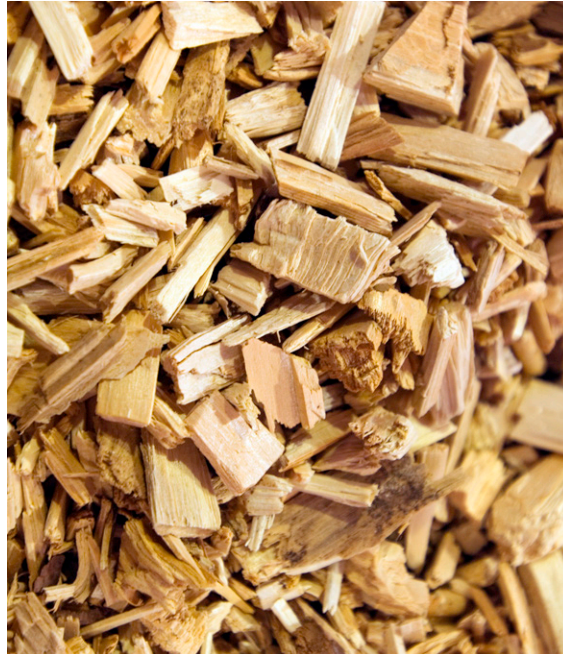
Aufbereitetes Altholz, Quelle: Reiling
