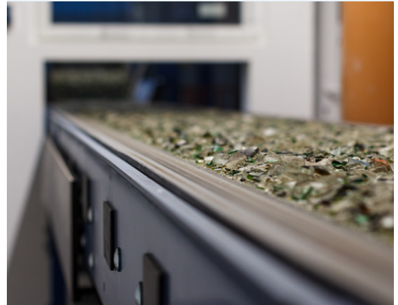
Glas in der Sortierung, Quelle: Reiling
