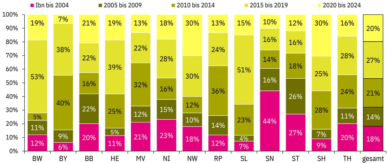
**Abbildung 9: Altersstruktur der installierte Windenergieleistung nach Jahr der Inbetriebnahme**
