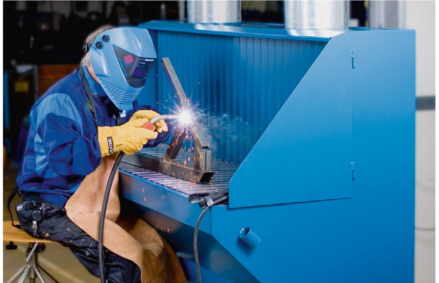
Bild 8: Absaugtisch mit Absaugwand
