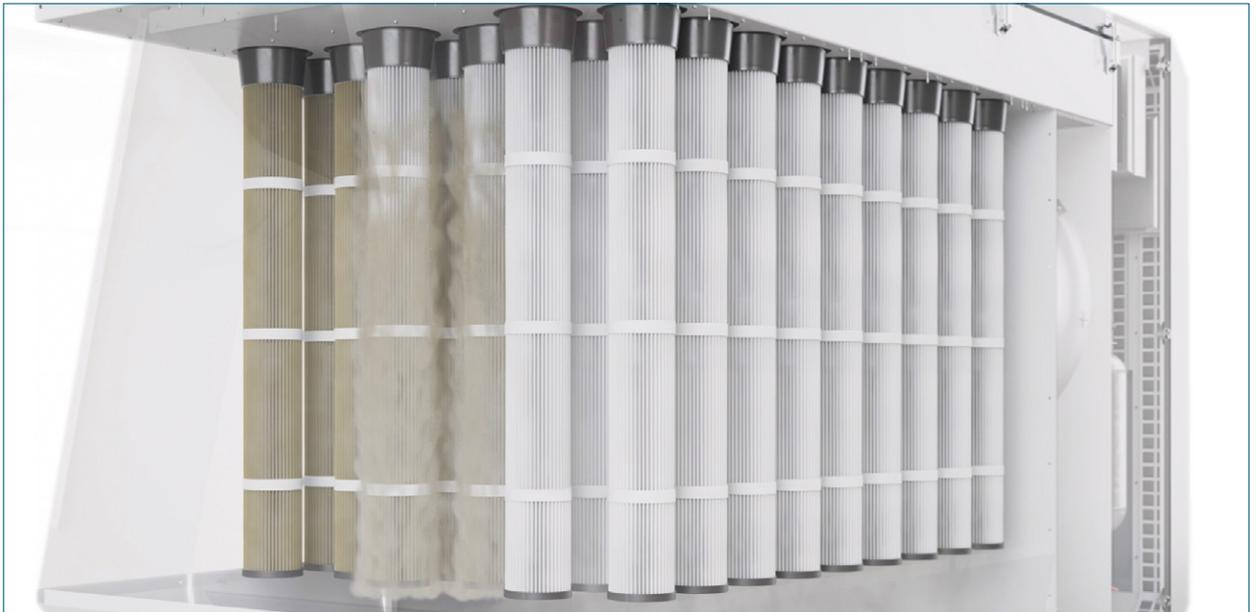
Bild 17: Schematische Darstellung bestaubter Filterelemente vor, während und nach der Filterabreinigung
