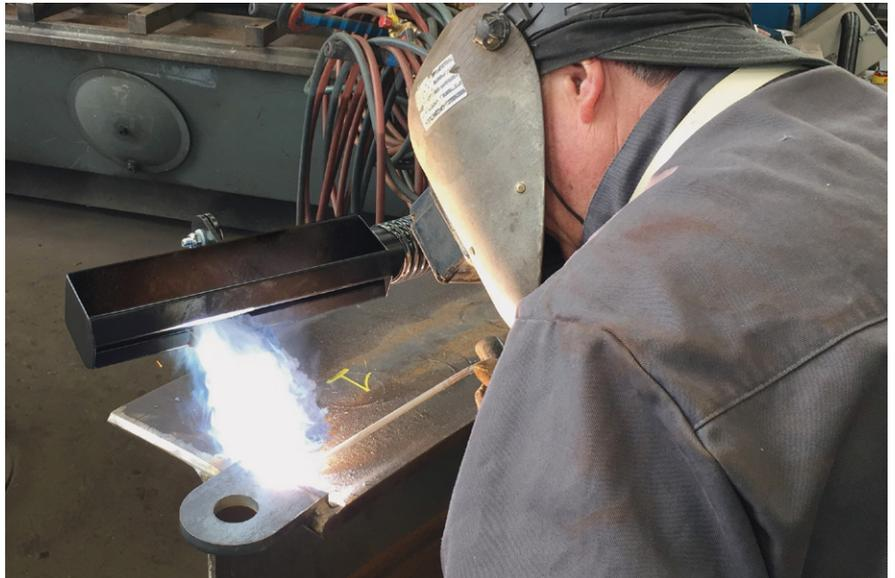
Bild 6: Absaugung mittels Saugdüse
