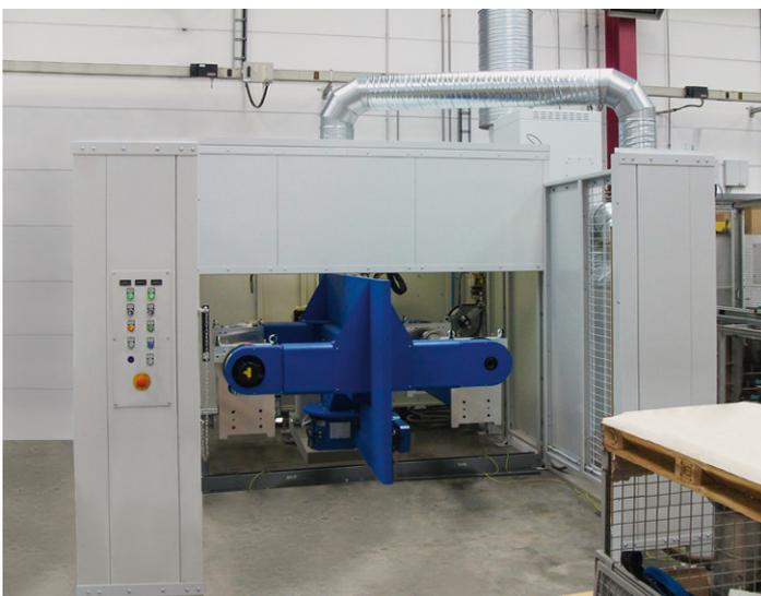
Bild 10: Einhausung eines Schweißroboters
