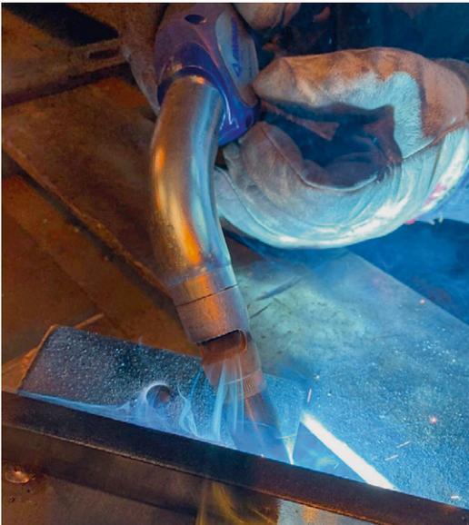
Bild 5: Schweißbrenner mit integrierter Absaugdüse
