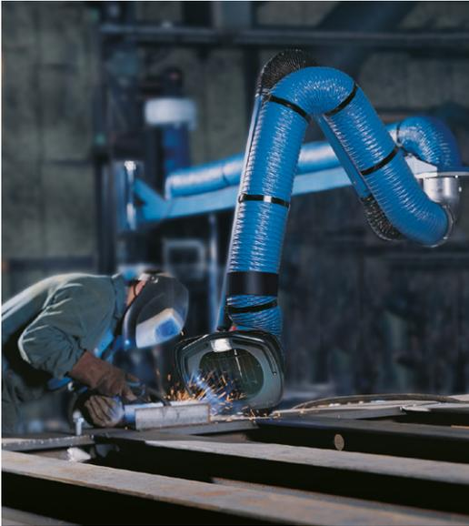
Bild 7: Absaugung mittels Absaugarm
