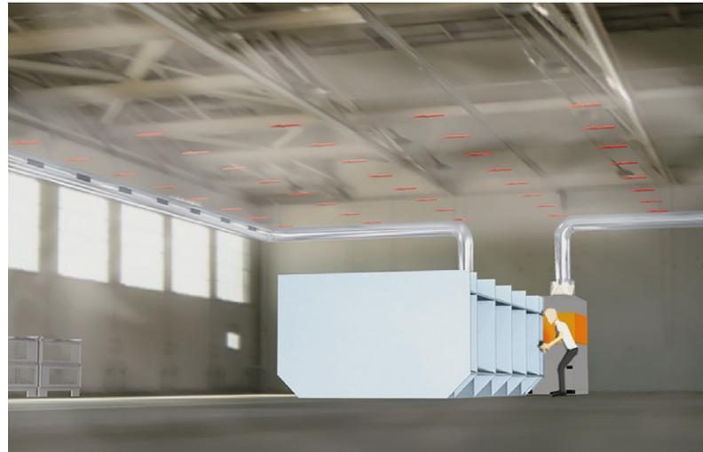
Bild 12: Schematische Darstellung der Mischlüftung
